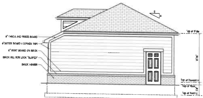
NORTH - RIGHT ELEVATION SCALE: 1/8" = 1'-0"
